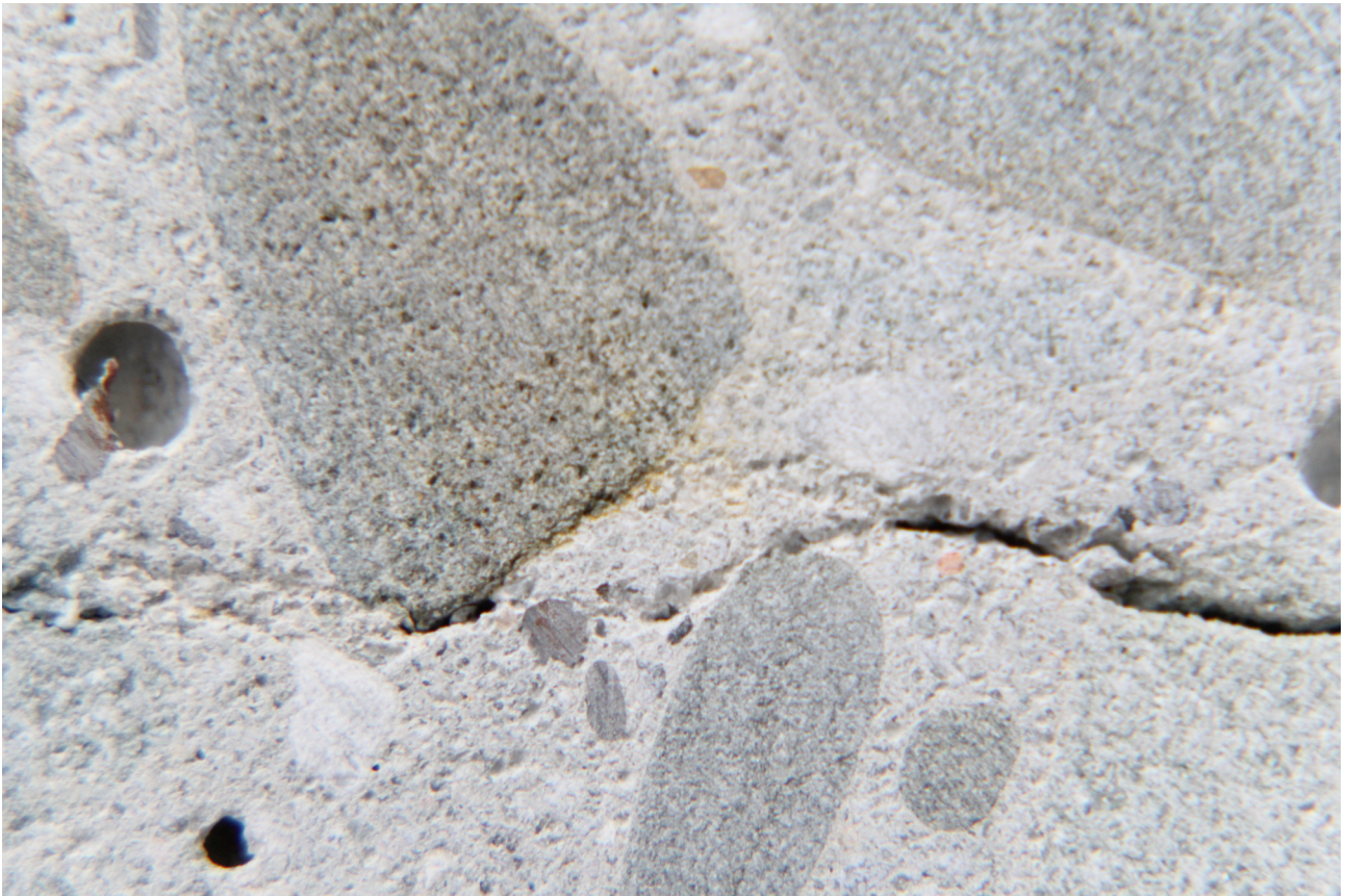
Fot. 2. Rysa w zbliżeniu – wydaje się pojawiać i znikać, co spowodowane jest procesem zarastania. Światło dzienne plus światło sztuczne.
