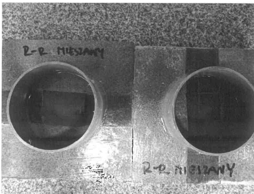
Rys. 2 Próbkę Maty Penetrującej poddana działaniu wodnego roztworu o zawartości jonów: NH 4 + : 100 mg/l, SO 4 2- : 6000 mg/l, Mg 2+ : 3000 mg/l, CO 2 agresywne: 100 mg/l, Sodu chlorek: 20 %.
