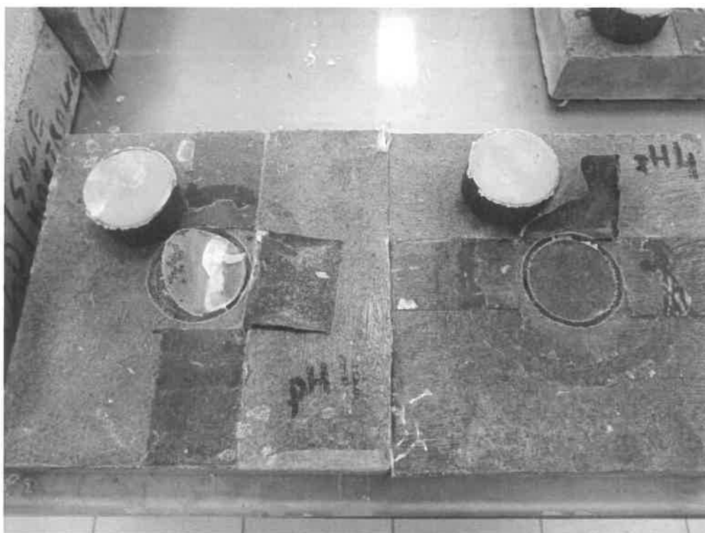
Rys. 6 Próbka Maty Penetrującej po badaniu przyczepności po działaniu wody zakwaszonej do pH=4.
