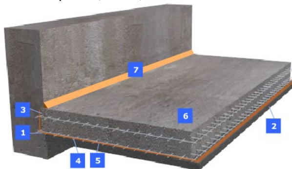
Rys. 1. Uszczelnianie spodu płyty dennej i zamka ściany szczelinowej: 1-zamek; 2-chudy beton pod płytą; 3-uszczelnienie zamka; 4-zbrojenie; 5-równomiernie rozsypany produkt Hydrostop-Mieszanka; 6-beton płyty; 7-klin przyścienny.
